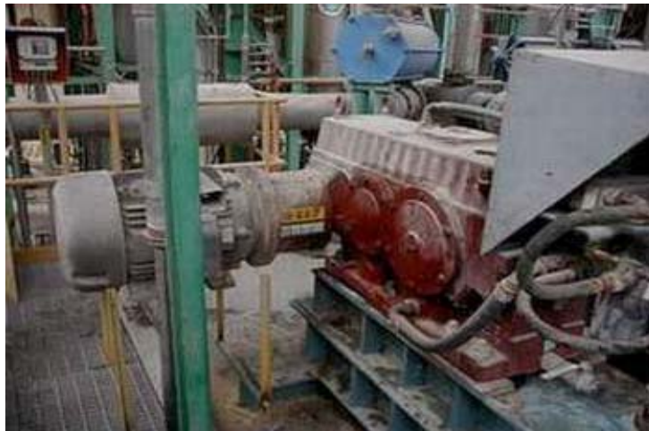
Figura 5.1 Accionamiento del Alimentador de alta presión. Nótese que el motor esta en voladizo, y los ejes están en posición horizontal.
